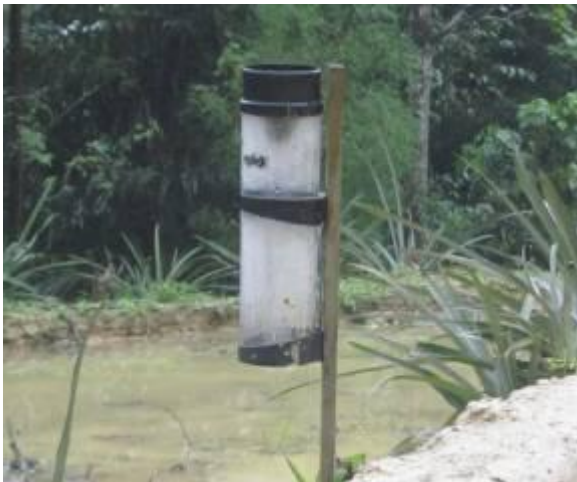
Hình 3.1: Dụng cụ đo lượng mưa
